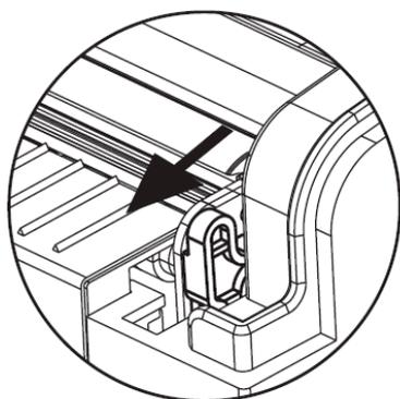
Рычаг поднят: ролик отделителя заблокирован.
