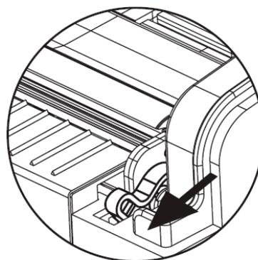
Рычаг опущен: ролик отделителя разблокирован.
