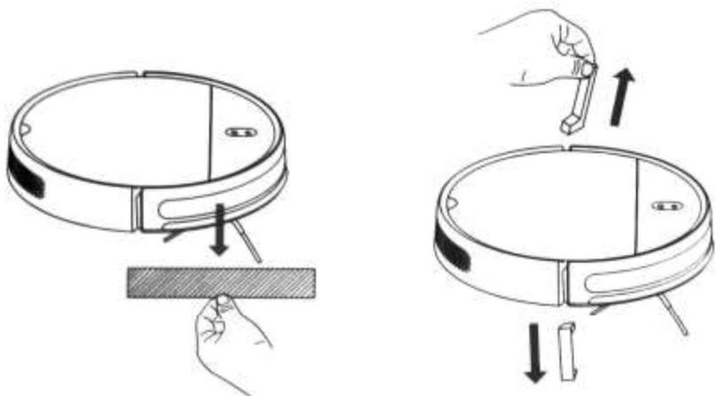
2. Откройте нижнюю крышку зарядного устройства, подключите шнур питания. При необходимости разместите лишнюю часть шнура в скрытом отсеке. Снимите защитную пленку.
