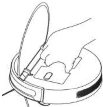
2. Снимите фильтрующий элемент, разберите его на компоненты для тщательной очистки.
