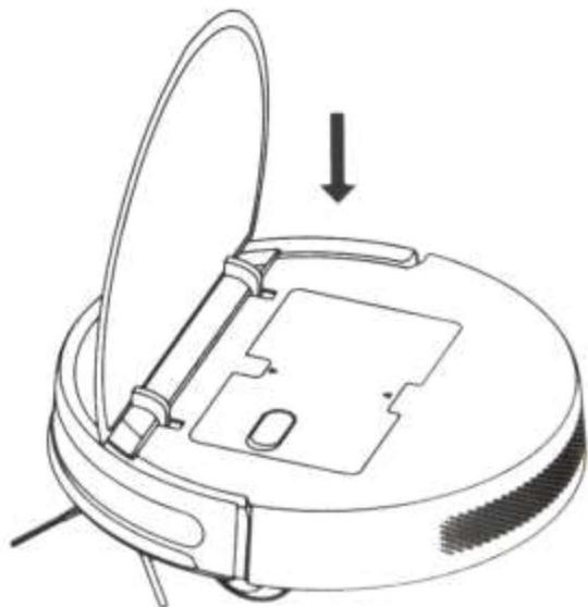
1. Откройте крышку для роботы-пылесоса и установите резервуар 2в1 в указанном направлении до полной фиксации.
