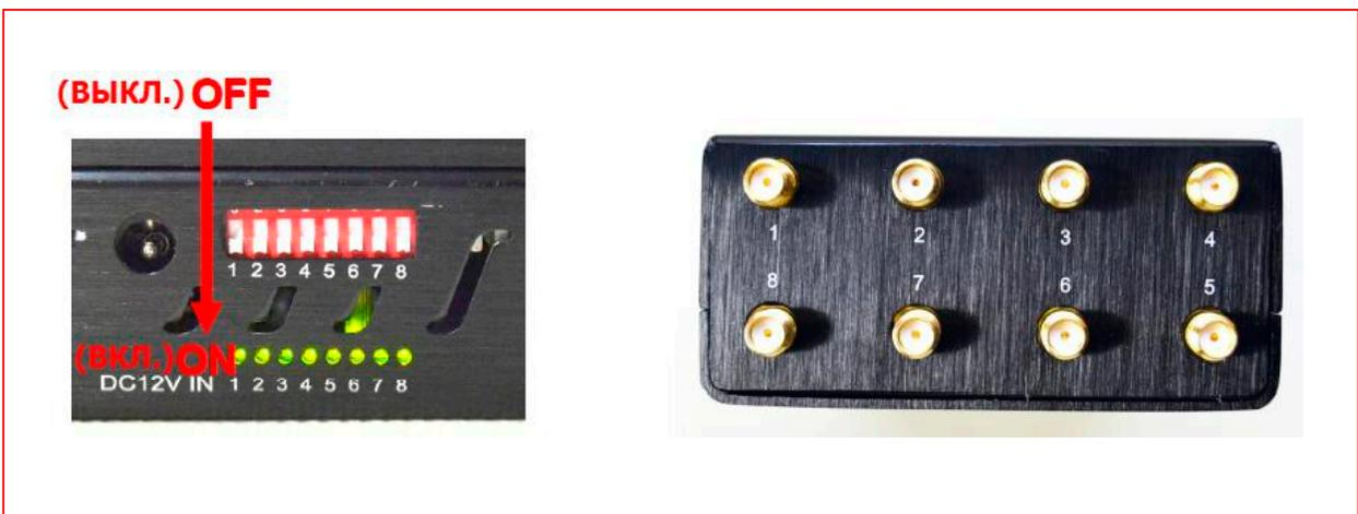
2. На панели расположены восемь переключателей ON → OFF, которые отвечают за вкл./выкл. каждого из диапазонов по отдельности.
